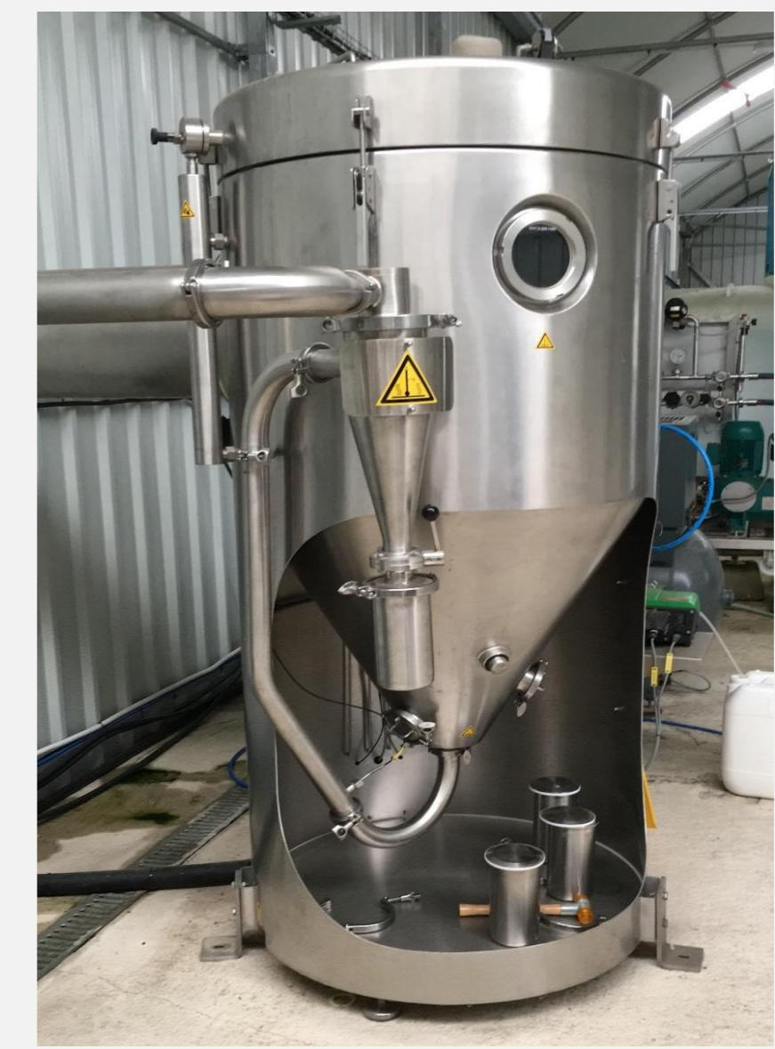
Se evaluaron cinco lodos con concentraciones diferentes (20, 30, 60, 80 y 150 g/L) y seis temperaturas de entrada (240, 220, 200, 180, 160 y 140 °C), estableciendo la temperatura de salida en 90 °C. Además se evaluó el coste energético de secar 1 kg de biomasa con el fin de verificar si el proceso es o no económico viable.
